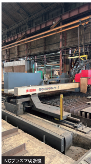
NCプラズマ切断機
