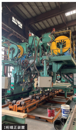
I桁矯正装置
